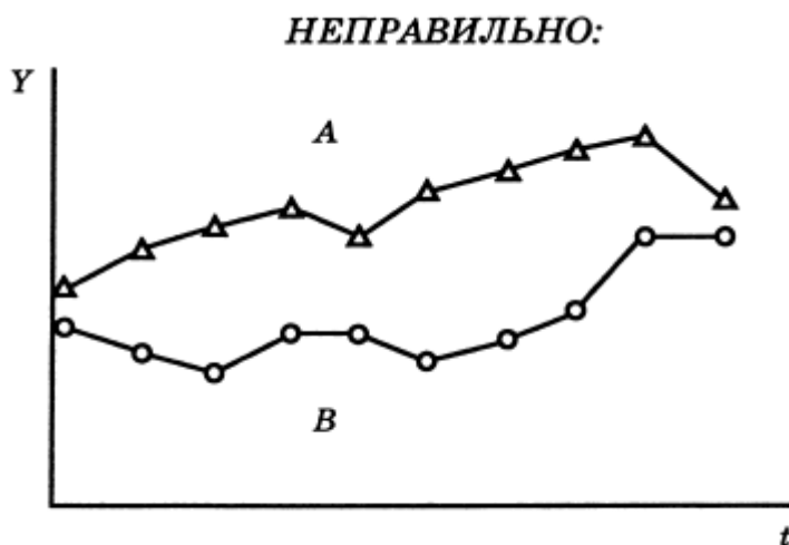
Рис. 18. Представлены только средние, статистический разброс не обозначен, данные о числе объектов в каждой выборке также отсутствуют. Суждение о различии между A и B – принципиально невозможно. t – время
