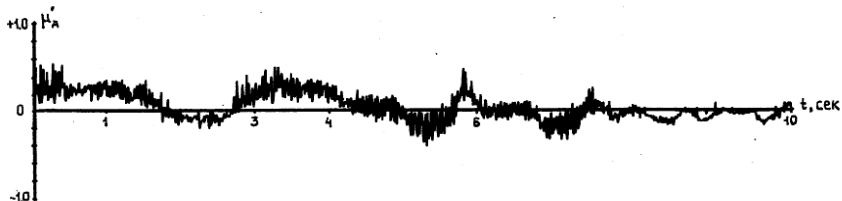
Рис.3.20. Временные зависимости параметра ЭПР \sigma_H(t) и поляризационного параметра \mu'_A(t) для составного РЛ объекта " вода + движущееся судно-толкач с ненагруженной баржей " (рис.3.9.д). 15.06.87. R = 4.11 км ; Ант = 760 мм ; Vветра = 1 - 3 м/сек.
