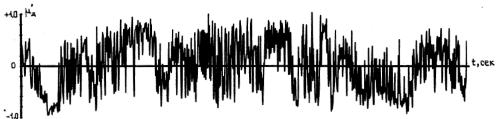
Рис.3.32. Временные зависимости параметра ЭПР \sigma_H(t) и поляризационного параметра \mu'_d(t) для РЛ объекта "находящийся в полете вертолет".
