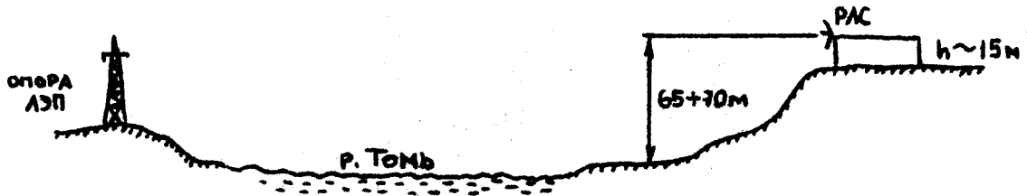
Рис.3.7. Схематическое изображение рельефа местности, прилегающей к зданию ( h = 15 \text{ м} ), в котором размещался макет поляризационной обзорной РЛС.
