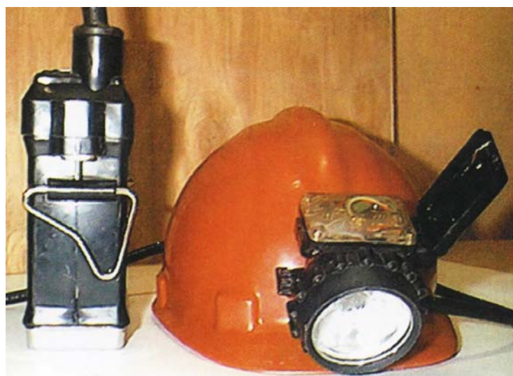
Разработка СКБ «Смена» – сигнализатор метана, встроенный в шахтерский шлем
