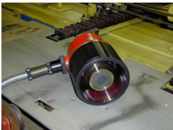
Электронная пушка с плазменным катодом для сварки тепловыделяющих элементов атомных станций, разработанная на кафедре физики. 1980-е годы
