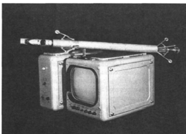
Малогабаритная телевизионная установка кафедры ТУ для осмотра труб лонжеронов вертолетов. 1960-е годы
